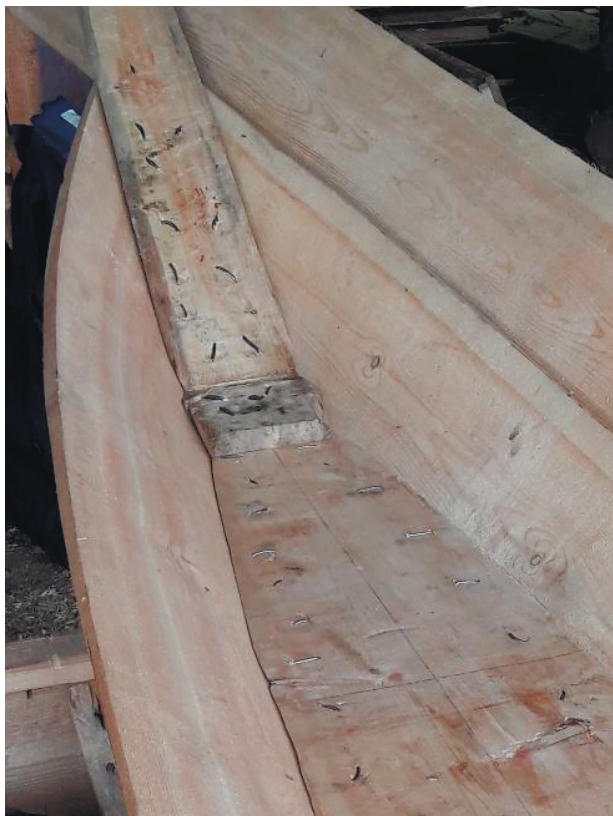
Рис. 6. Гвоздевое крепление досок
