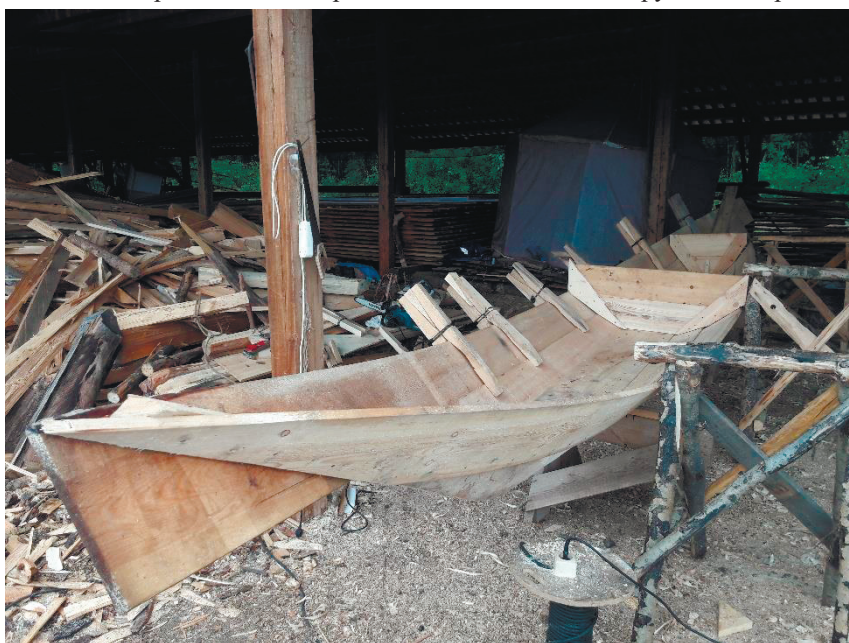
Рис. 8. Фиксация верхнего набоя к нижнему при помощи зажимов-прищепок
