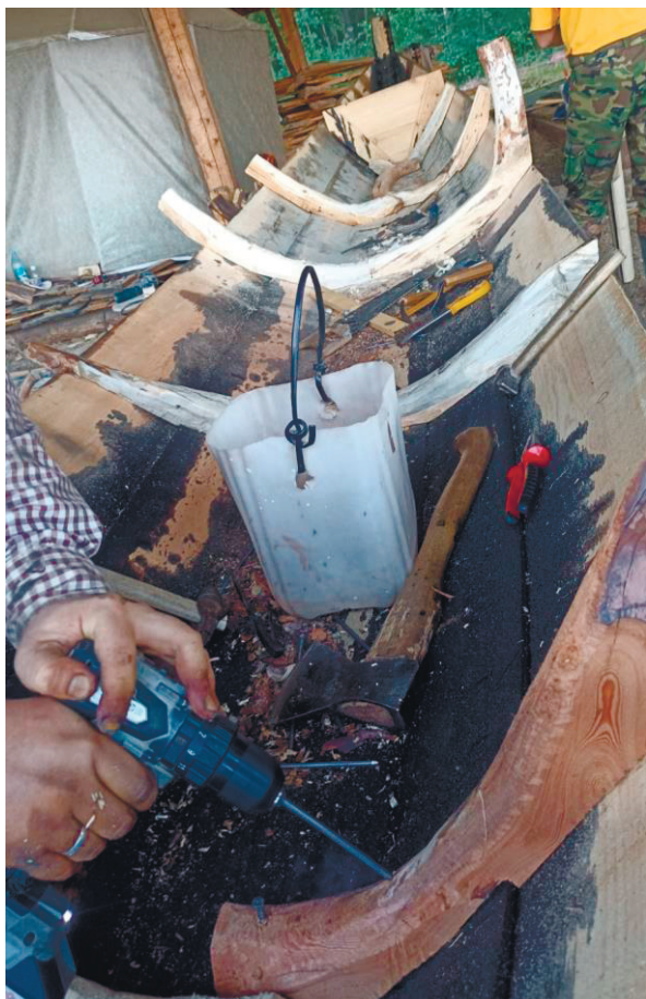
Рис. 9. Монтаж шпангоутов (упруг)
