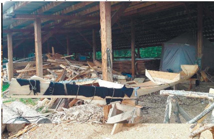
Рис. 5. Обшивка каркаса досками первого набоя
