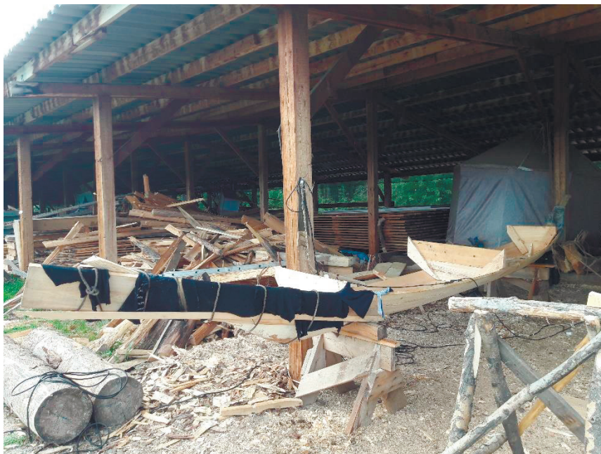
Рис. 7. Гнутьё доски второго набоя с использованием смоченных водой тряпок
