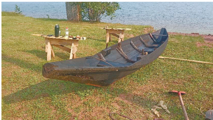
Рис. 12. Готовый шитик после повторной конопатки и смоления
